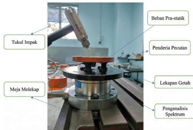
Rajah 1. Persediaan eksperimen teknik impak
