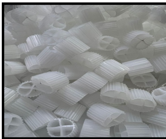
Fig. 2. Kaldnes K1 biofilm media carrier
